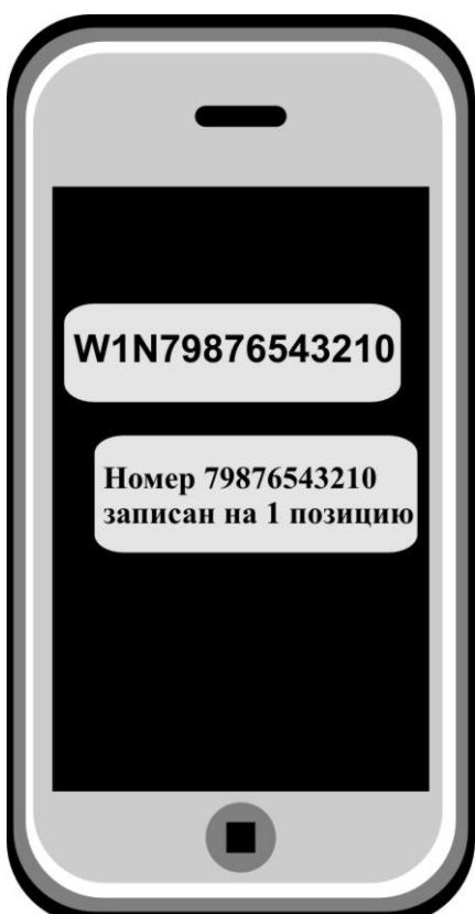
Все номера в телефонной книге устройства являются равнозначными. При тревоге в контрольной зоне или отключении\включении основного питания рассылка сообщений будет произведена на все номера, записанные в телефонную книгу. В случае, если при голосовом звонке первый номер телефонной книги не отвечает, звонок будет произведен на следующие номера.
